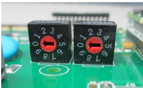
Abbildung 24: IP Adresseneinstellung mit BCD Drehschaltern
